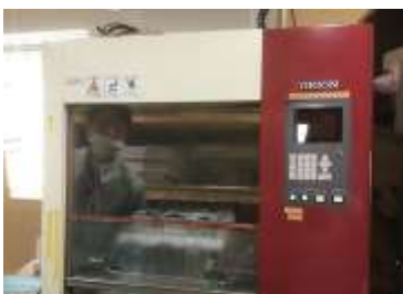
写真-2 使用した恒温槽(協力: ㈱スノーテック新潟)
