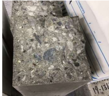
写真-3 No.1（標準配合 0：0） （通常の碎石粗骨材が割れることなく、残っている）
