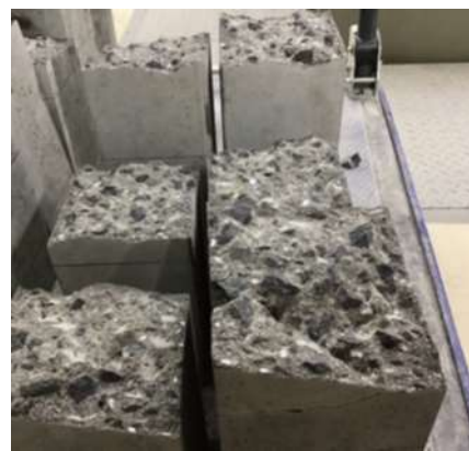
写真-4 No3（置換率 細骨材 100%：粗骨材 0%） （通常の碎石粗骨材が割れているものもある）
