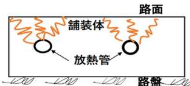
図-3 ロードヒーティング断面模式図
