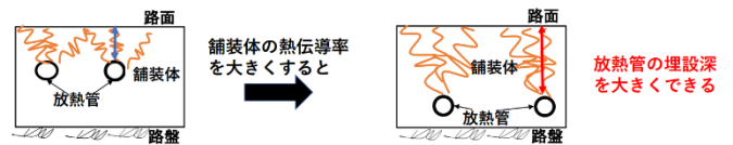
図一5 舗装体断面図の防護力強化の模式図
