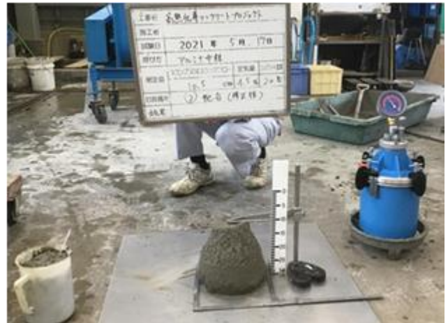
写真-5 アルミナ中粒を使用した時の性状写真
