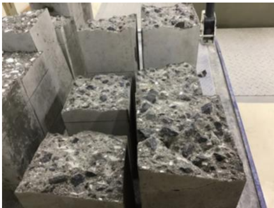
写真-4 No3 (置換率細骨材100%粗骨材0%) : 砕石粗骨材が割れているものもある
