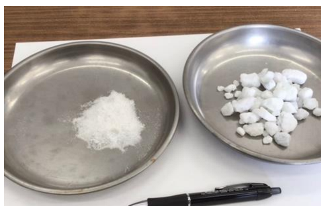
写真-1 使用した日本軽金属(株)製のアルミナ「36 W/m・K (25°C)」
