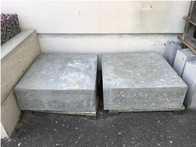
写真-5 屋外暴露試験状況(撮影日2021年8月2日) ※ 写真右は砂、砂利の100%を置換、写真左は砂、砂利の50%を置換したもの1年9か月経過したが、目視ではコンクリート表面には変化が見られない
