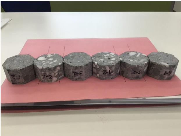
写真－2 熱伝導測定用サンプル(直径 5cm の八角形、厚さ 3cm)
