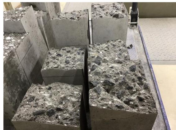
写真-5 No3: 砕石粗骨材が割れているものもある。
