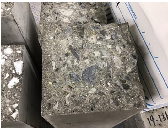
写真-3 No1 (標準配合) : 砕石粗骨材が割れることなく、そのまま残っている。
